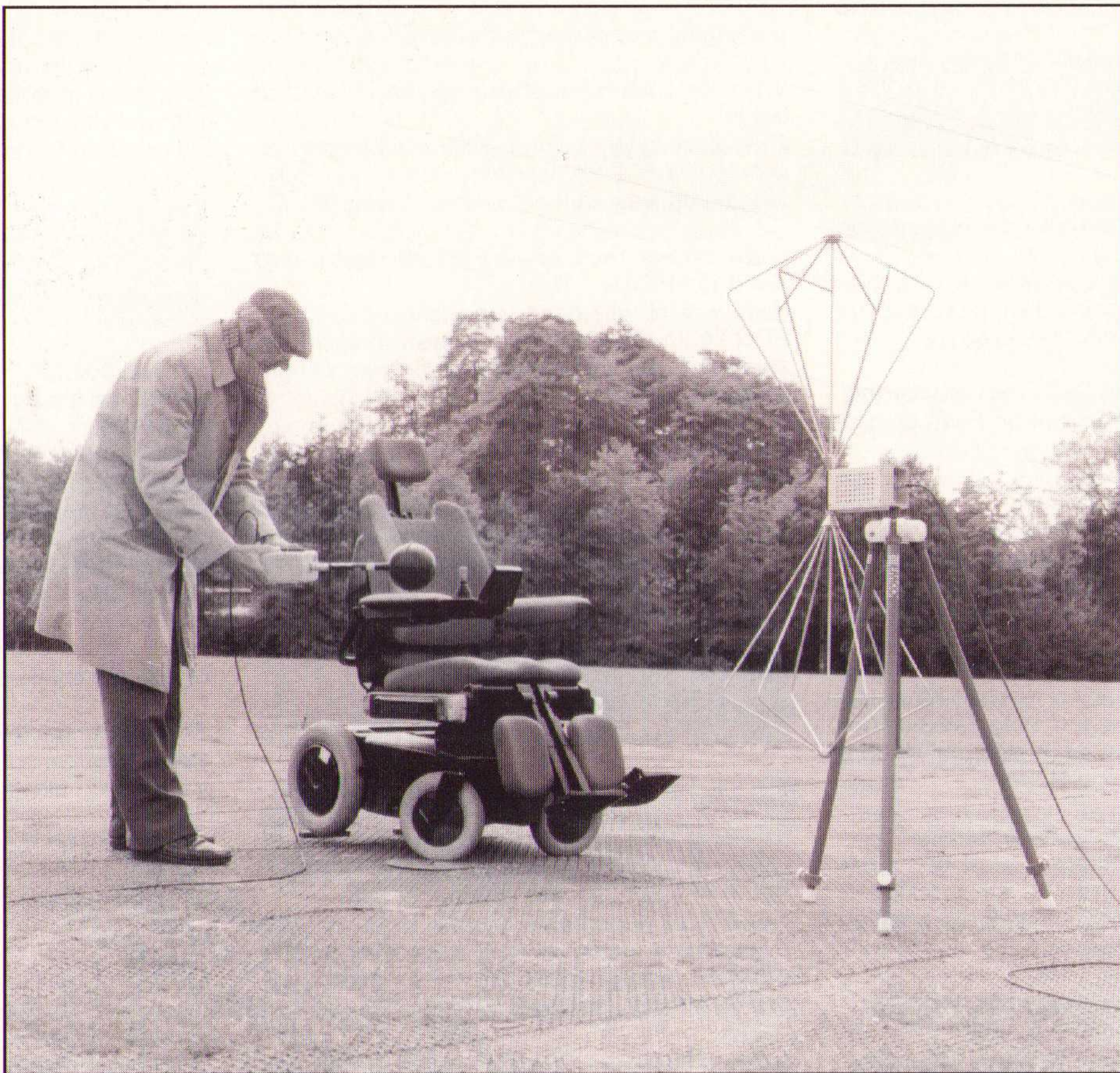
Elektrische rolstoelen vallen onder de EMC-richtlijn. Het mag niet zo zijn dat bijvoorbeeld een GSM-telefoon de stoel opeens laat rijden of doet stoppen.
